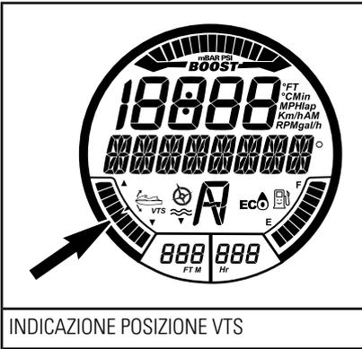
Il sistema VTS consente di modificare manualmente la posizione di assetto dell'iniettore, o di selezionare due posizioni di assetto preimpostate e di registrare o cambiare le posizioni di assetto preimpostate su certi modelli.
