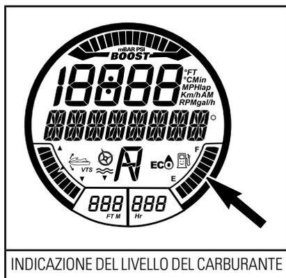
Quando il serbatoio del carburante è pieno, 8 segmenti dell'indicatore (barre) sono accesi. L'ultimo segmento non viene utilizzato.
