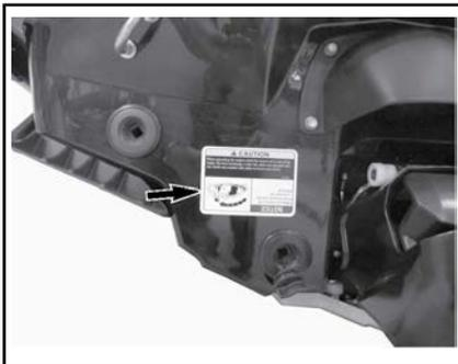
このエンジンには転覆保護システム (T.O.P.S.™) が装備されています。ウォータークラフトがひっくり返ると、エンジンは自動的に停止します。ウォータークラフトが本来の姿勢に戻ると、通常通りにエンジンを始動できます。
