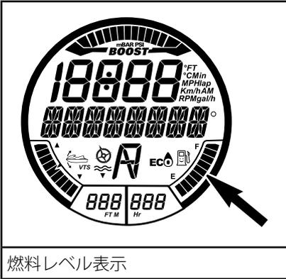
燃料タンクが満杯の場合、インジケータの8つセグメント (四角の点) 全部が点灯します。トップのセグメントは使用されません。
