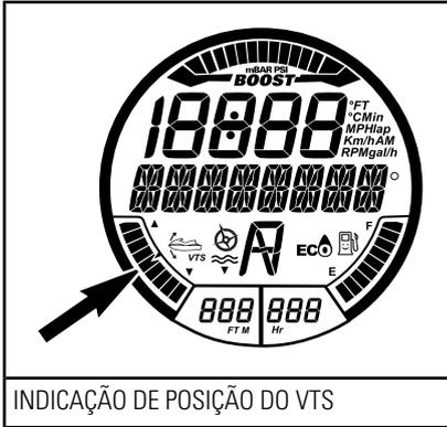
O sistema VTS permite ajustar manualmente a posição de ajuste do bocal, ou selecionar duas posições de ajuste predefinidas e registrar ou alterar as posições de ajuste de alguns modelos.
