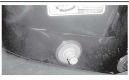
TÍPICA - ADAPTADOR DE CONEXÃO RÁPIDA PARA MANGUEIRA
