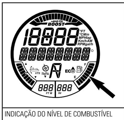
Quando o tanque de combustível está cheio, oito segmentos (barras) do indicador ficam acesas. O segmento superior não é usado.
