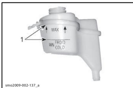
ТИПОВОЙ ВАРИАНТ — РАСШИРИТЕЛЬНЫЙ БАЧОК
