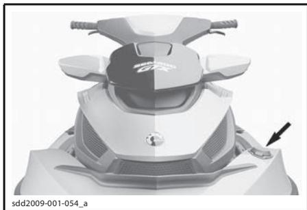
ТИПОВОЙ ВАРИАНТ — РАСПОЛОЖЕНИЕ КРЫШКИ ТОПЛИВОЗАПРАВОЧНОЙ ГОРЛОВИНЫ
