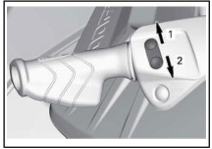
**DOUBLE-CLIQUER SUR LA FLÈCHE DU HAUT OU DU BAS DU BOUTON VTS POUR UTILISER LES PRÉRÉGLAGES**
