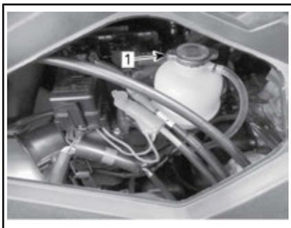
1. Bouchon de réservoir d'expansion
