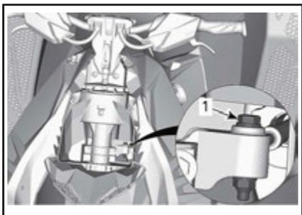
1. Parafuso de fixação do cabo de direção
