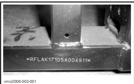
*NIV (NUMÉRO D'IDENTIFICATION DU VÉHICULE) ÉGALEMENT ESTAMPILLÉ SUR LE CHÂSSIS*
