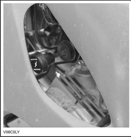
*CHOKE LEVER IN THE FULL CHOKE POSITION*
