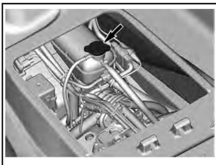
Lorsque la motomarine se trouve sur une surface horizontale et que le moteur est froid, le niveau du liquide doit être entre les marques MIN. et MAX. du réservoir.
