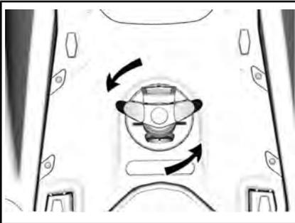
**AVIS** Il est très important d'installer le couvercle du mât de ski pour empêcher l'infiltration d'eau dans la coque.
