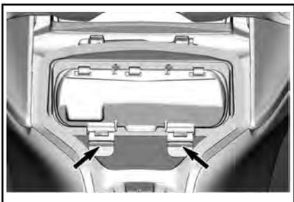
Une mousse de protection située à l'intérieur du compartiment étanche protège les téléphones. Assurez-vous que le téléphone intelligent soit maintenu en place par la mousse et non pas les rebords du compartiment et que vous puissiez fermer le couvercle. Vérifiez toujours que la mousse soit complètement sèche avant d'utiliser le compartiment.
