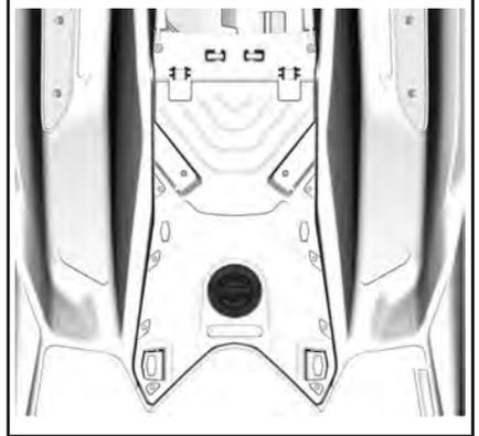
3. Retirez le couvercle du moteur en enlevant les vis de fixation.
