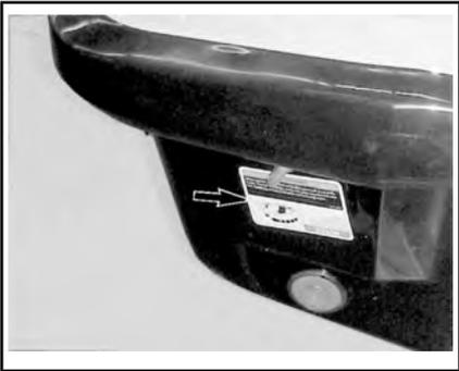
此 4-TEC™ 发动机配备有倾翻保护系统 (T.O.P.S.™)。当摩托艇翻覆时，发动机自动停止。
