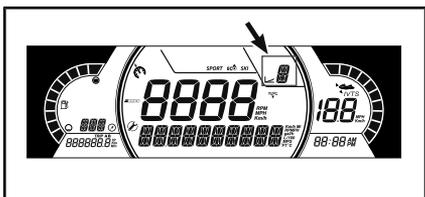
Diese Anzeige zeigt die Getriebestellung des iBR an:
