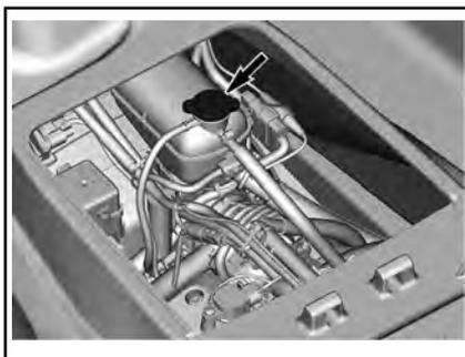
Bei horizontaler Lage des Wasserfahrzeugs sollte der Pegel bei kaltem Motor zwischen den Markierungen MIN. und MAX. am Kühlmittelbehälter stehen.
