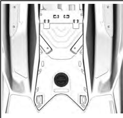
3. Nehmen Sie die Motorwartungsabdeckung ab, indem Sie die Halteschrauben entfernen.
