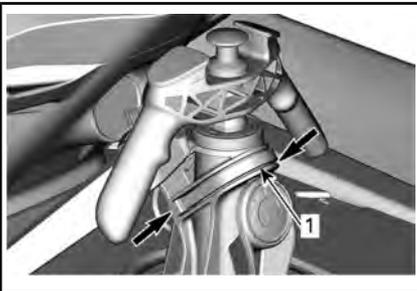
**TYPISCH - ZUM ENTRIEGELN NACH VORN SCHIEBEN UND DEN ZUGMAST HERAUSZIEHEN**
