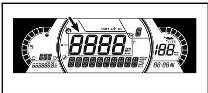
In der mittleren Anzeige wird die Fahrzeuggeschwindigkeit angezeigt.
