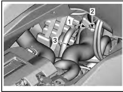
1. Ausrichtungslinien am Schlauch
