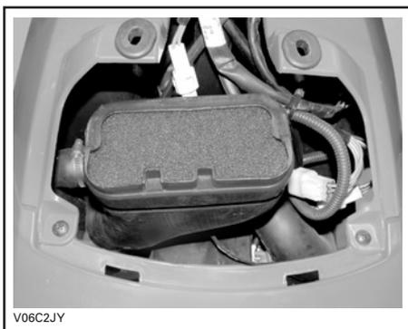
Verser une solution nettoyante ((N/P 219 700 341) ou l'équivalent) dans un seau et y mettre le filtre à tremper.
