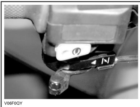
Appuyer sur le bouton de démarrage du moteur et le maintenir jusqu'à ce que le moteur démarre.
