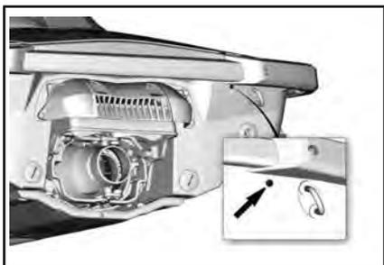
**RACCORDO TRABOCCAMENTO INTER-COOLER**
