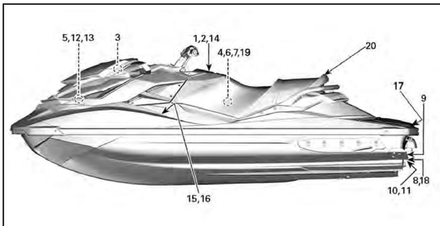
POSIZIONE DELLE ETICHETTE DI SICUREZZA SULL'IMBARCAZIONE
