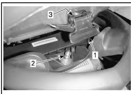
**CONFIGURAZIONE TIPICA - DISPOSITIVO DI CHIUSURA DEL SEDILE**
