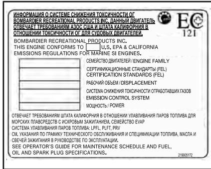
НАКЛЕЙКА 2 - ПРИМЕНИМО ДЛЯ ВСЕХ МОДЕЛЕЙ В КАНАДЕ И СОЕДИНЕННЫХ ШТАТАХ, ПРИМЕНИМО ВЕЗДЕ ЗА ИСКЛЮЧЕНИЕМ КАНАДЫ И США ДЛЯ МОДЕЛЕЙ, ЭКВИВАЛЕНТНЫХ МОДЕЛИ, СЕРТИФИЦИРОВАННОЙ В СООТВЕТСТВИИ С ТРЕБОВАНИЯМИ АЗОС США EPA STANDARDS
