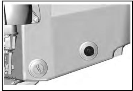
*ТИПОВОЙ ВАРИАНТ – ПЕРЕХОДНИК БЫСТРОРАЗЪЕМНОГО СОЕДИНЕНИЯ*
