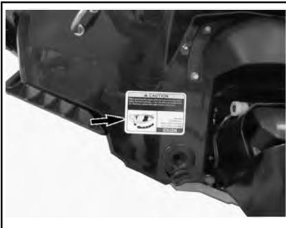
Двигатель имеет систему защиты при переворачивании (T.O.P.S.™). При опрокидывании гидроцикла двигатель автоматически выключает.
