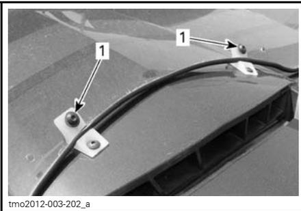
1. Suportes com os parafusos de retenção e as arruelas instalados
