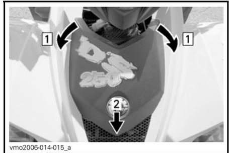
Schritt 1: Vordere Nase von Durchgangsstüllen abziehen
