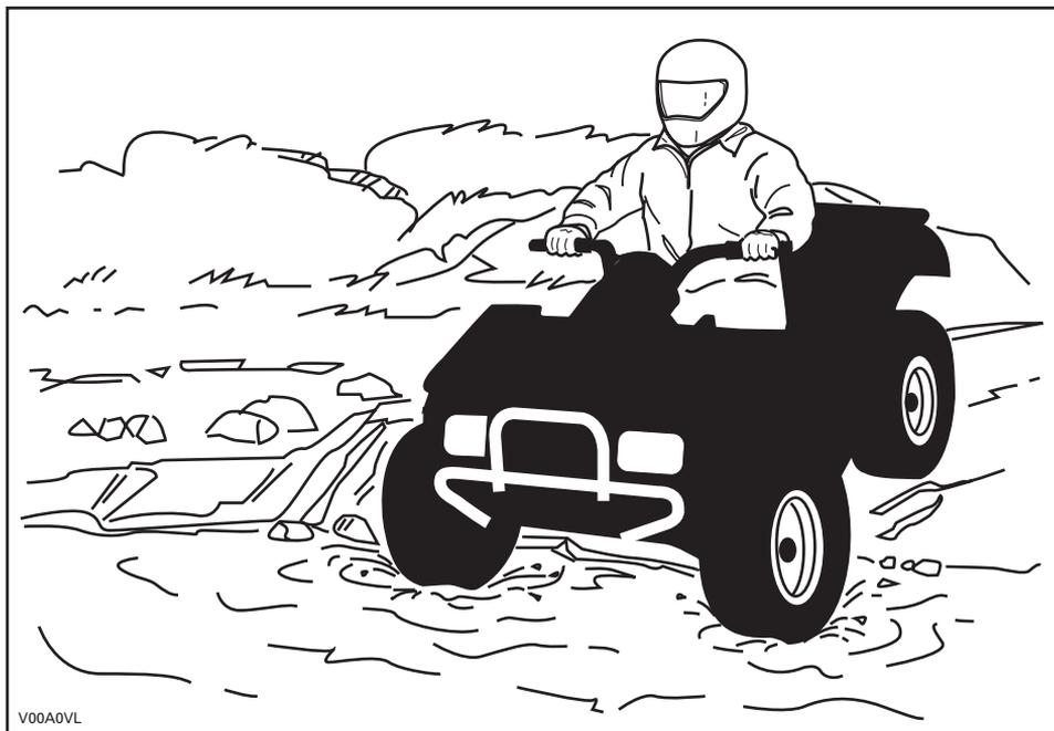
El agua afecta a la capacidad de frenado del vehículo. Asegúrese de que se sequen los frenos; para ello, accíonelos varias veces después de salir del agua con el vehículo.
