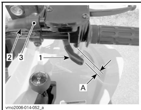
1. Palanca del acelerador
