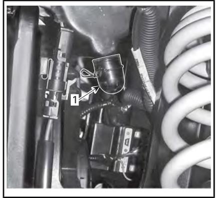
1. Entfernen Sie die Ablassschraube, um Wasser abzulassen
