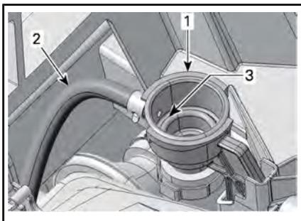
1. Adapter zum Auffüllen des Kühlsystems
