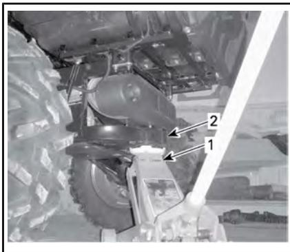
1. Hydraulischer Wagenheber
