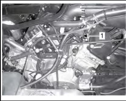
1. Entlüftungsschraube des vorderen Zylinders
