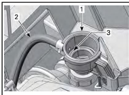
1. Adapter zum Auffüllen des Kühlsystems
