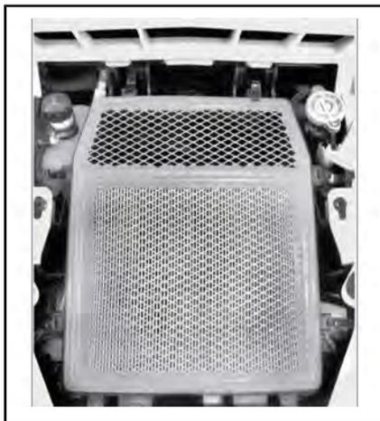
3. Stellen Sie vor dem Schließen der Klemmen sicher, dass die Abdeckung sicher auf dem Motor-Luftfilterkasten sitzt.
