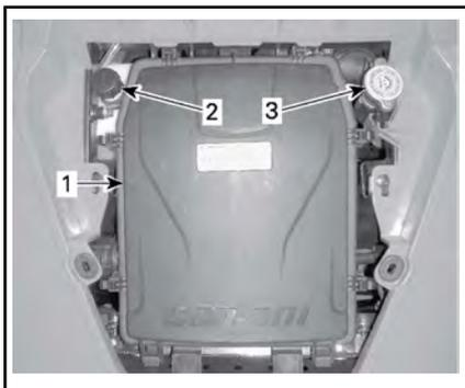
1. Deckel des Motor-Luftfilterkastens
