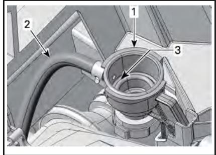
1. Adapter zum Auffüllen des Kühlsystems
