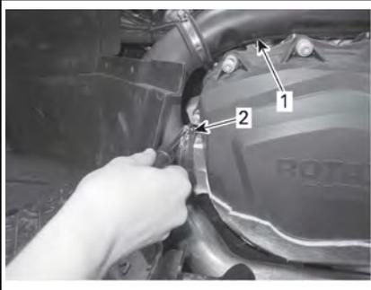
1. Auslassschlauch des stufenlosen Getriebes
