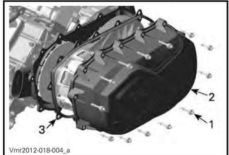
1. Vis inférieures du couvercle de transmission
