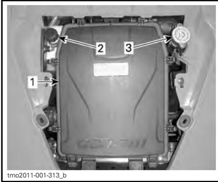
1. Couverture de boîtier du filtre à air du moteur
