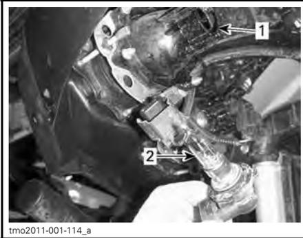
1. Douille de l'ampoule
