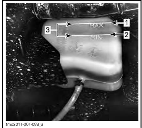
**RÉSERVOIR D'EXPANSION DU LIQUIDE DE REFROIDISSEMENT**
