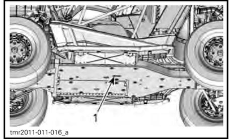
1. Accès au bouchon de vidange du système de refroidissement
