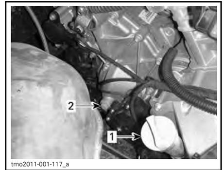
1. Bouchon de niveau d'huile du moteur
