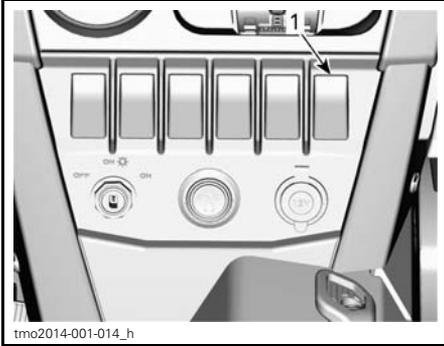
1. Interrupteur de commande de treuil
