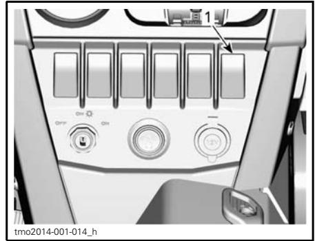
1. Interrupteur de commande de treuil
