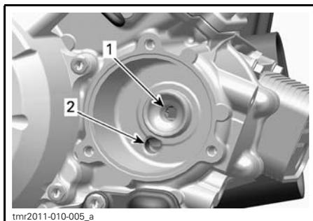
1. Orifice de sortie allant au système d'alimentation en huile du moteur
