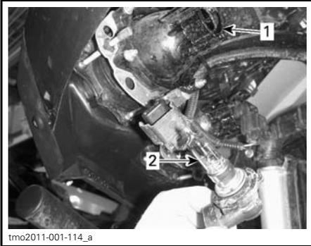
1. Douille de l'ampoule
