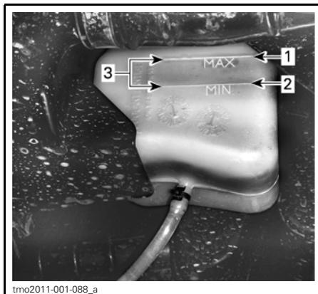
**RÉSERVOIR D'EXPANSION DE LIQUIDE DE REFOUILLISSEMENT**
