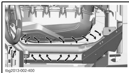
2. À l'aide d'un boyau d'arrosage, nettoyer soigneusement la zone afin qu'il n'y ait plus aucun débris en contact avec l'échappement.
