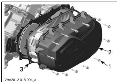
1. Vis inférieures du couvercle de transmission
