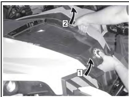
1. Heben Sie die Vorderseite der Wartungsabdeckung weiter an
