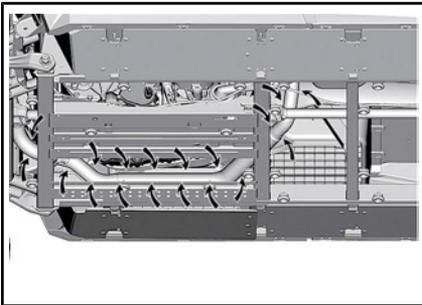
2. Utilizando una manguera de jardín, limpie la zona con esmerido de modo que no queden restos de suciedad en contacto con el escape.
