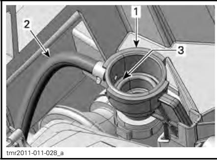
1. Goulot de remplissage du système de refroidissement
