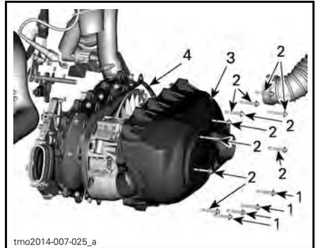
1. Vis inférieures du couvercle de transmission
