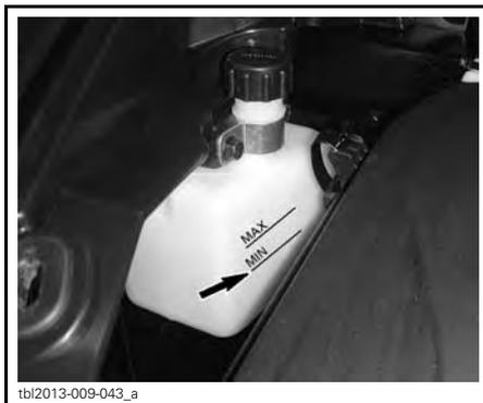
RÉSERVOIR D'EXPANSION DE LIQUIDE DE REFROIDISSEMENT
