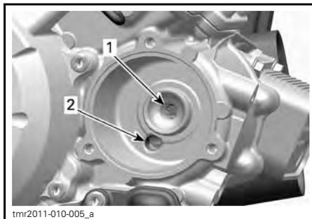
1. Orifice de sortie allant au système d'approvisionnement en huile du moteur
