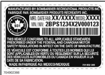
TYPICAL — VEHICLE SERIAL NUMBER LABEL UNDER GLOVE BOX
