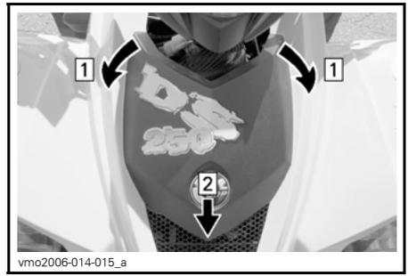
Schritt 1: Vordere Nase von Durchgangsstüllen abziehen
