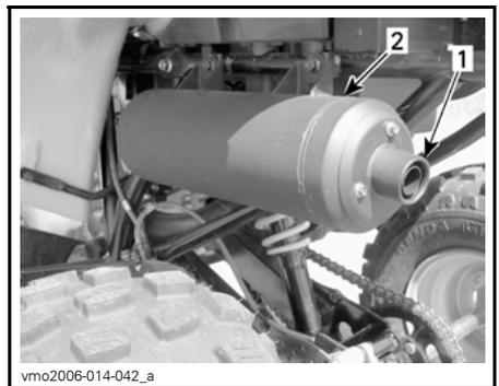
1. Ausgang des Auspufftopfs entfernen
