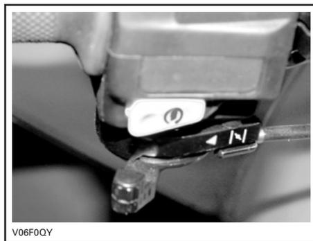
**CHOKE IN VOLLSTÄNDIG GEÖFFNETER POSITION**
