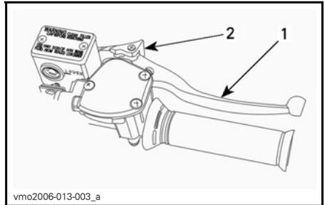
1. Bremshebel für vordere Bremse
