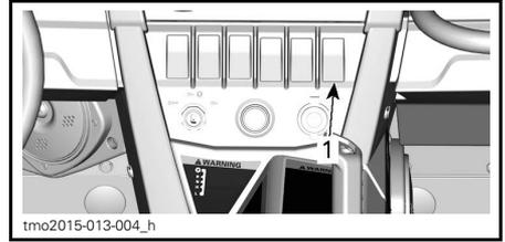
1. Interrupteur de commande de treuil
