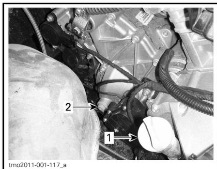
1. Bouchon de niveau d'huile du moteur
