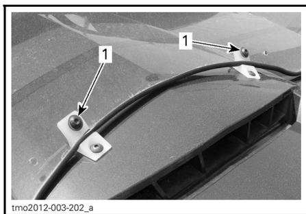
1. Vis de fixation retenant le pare-brise à la ferrure
