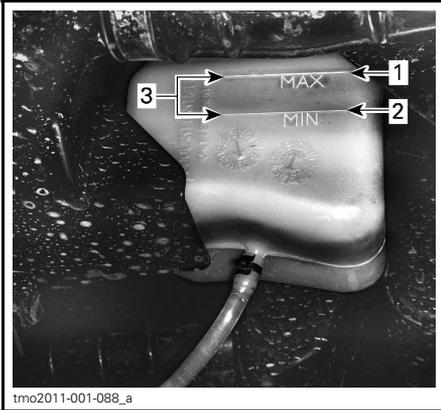
**RÉSERVOIR D'EXPANSION DE LIQUIDE DE REFROIDISSEMENT**
