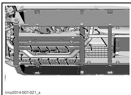
2. À l'aide d'un boyau d'arrosage, nettoyer soigneusement la zone afin qu'il n'y ait plus aucun débris en contact avec l'échappement.
