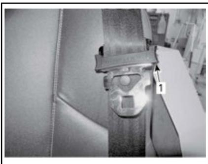
**CINTURÓN DE SEGURIDAD ACCIONADO****1. Pestaña de bloqueo de deslizamiento**
