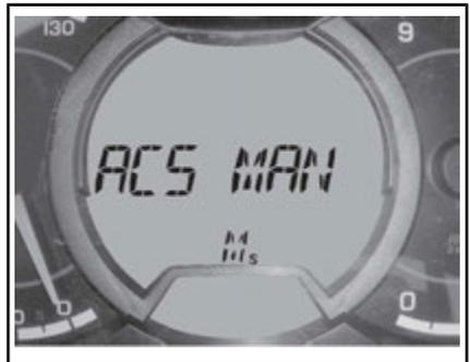
**NOTA:** Los indicadores de combustible y temperatura se convertirán en indicadores de la configuración de ACS trasera y delantera respectivamente.
