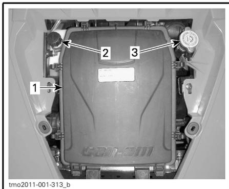
1. Couverture du boîtier du filtre à air
