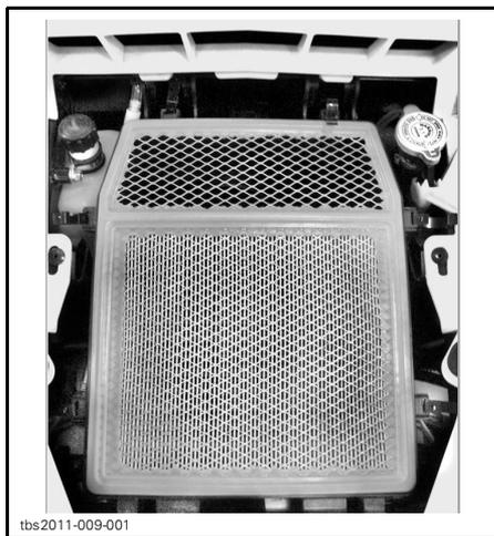
3. S'assurer que le couvercle repose bien contre le boîtier du filtre à air du moteur avant d'enclencher les fixations.
