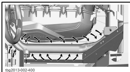
2. À l'aide d'un boyau d'arrosage, nettoyer soigneusement la zone afin qu'il n'y ait plus aucun débris en contact avec l'échappement.
