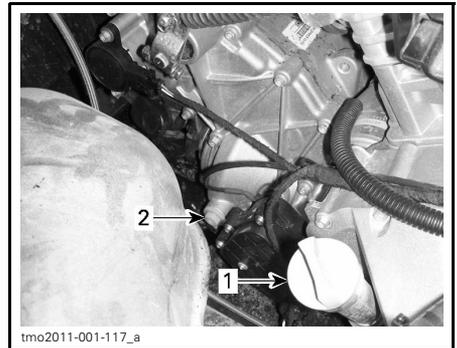
1. Bouchon de niveau d'huile du moteur
