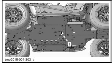
1. Accès au bouchon de vidange du système de refroidissement
