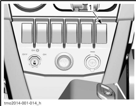
1. Interrupteur de commande de treuil
