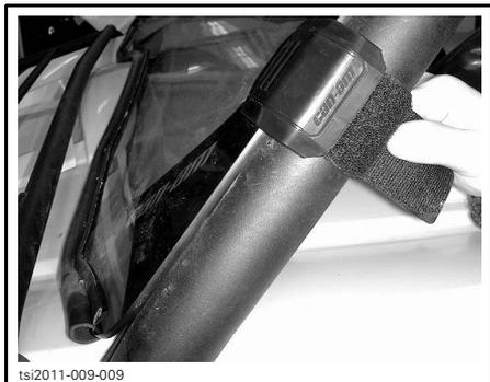
2. Enlever et conserver l'écrou de fixation, la rondelle et la vis qui retiennent le pare-brise à la ferrure.
