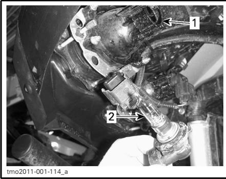
1. Douille de l'ampoule
