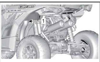
1. Sujeción que fija el filtro de aire de la CVT a la entrada de la CVT
