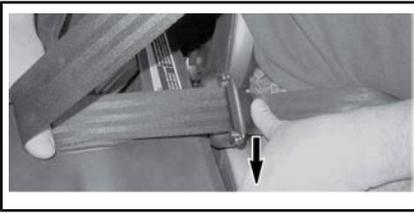
Para desabrochar el cinturón, pulse el botón rojo en la placa de cierre del cinturón de seguridad.
