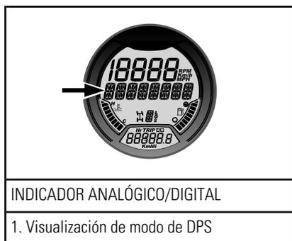
Para cambiar el modo de DPS, siga el procedimiento que se indica a continuación:
