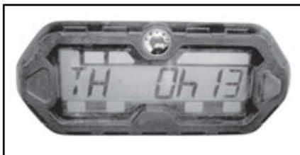
Pulse y MANTENGA presionado el botón selector durante 2 segundos para que el contador de horas se ponga a cero.
