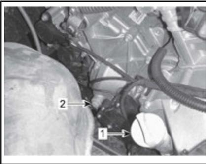
1. Varilla de medición del nivel de aceite del motor
