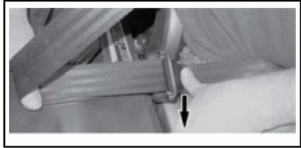
Para desabrochar el cinturón, pulse el botón rojo en la placa de cierre del cinturón de seguridad.
