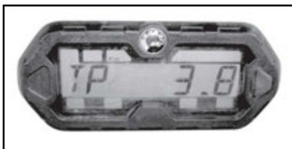
Puede utilizarse si se desea establecer un intervalo para repostar combustible o una distancia entre dos puntos de un itinerario.
