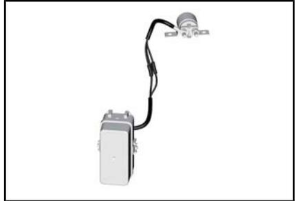
SCHMELZLOT VERBUNDEN MIT SICHERUNGSKASTEN
