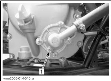
1. Bouchon de vidange du liquide de refroidissement
