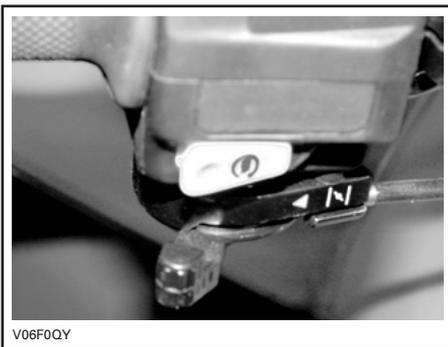
LEVA DEL DISPOSITIVO DELL'ARIA IN POSIZIONE COMPLETA
