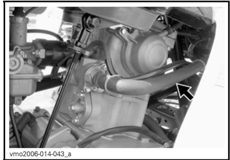
POSIZIONE PINZA DI STROZZAMENTO
