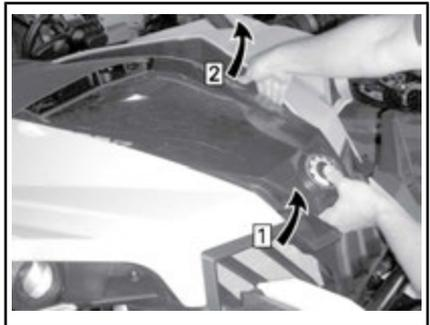
Passo 1: Mantenha levantada a parte frontal da tampa de manutenção
