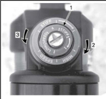
**AMORTECIMENTO DE COMPRESSÃO DE ALTA VELOCIDADE (USE UMA CHAVE INGLESA DE 17 MM)**
