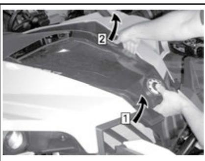
Passo 1: Mantenha levantada a parte frontal da tampa de manutenção
