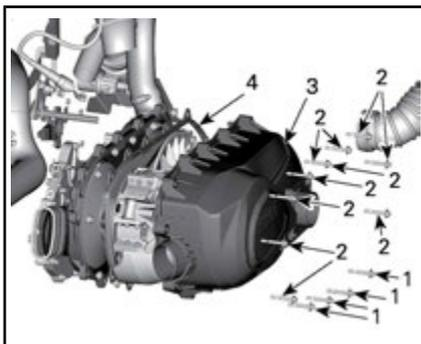
1. Parafusos inferiores da tampa da CVT
