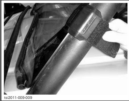
Installer les vis de fixation dans le pare-brise et les serrer au couple recommandé.
