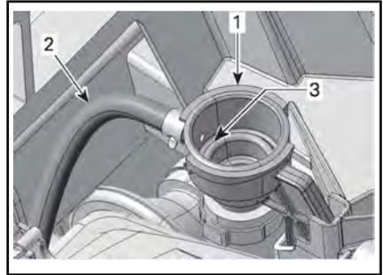
1. Adapter zum Auffüllen des Kühlsystems
