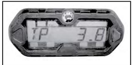
Sie kann verwendet werden, um die Reichweite einer Tankfüllung oder die Entfernung zwischen zwei bestimmten Punkten zu bestimmen.
