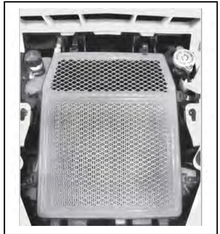
3. Stellen Sie vor dem Schließen der Klemmen sicher, dass die Abdeckung sicher auf dem Motor-Luftfilterkasten sitzt.
