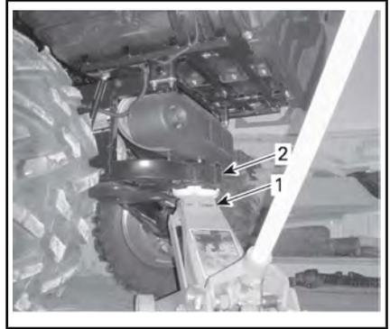
1. Hydraulischer Wagenheber
