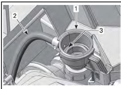
1. Adapter zum Auffüllen des Kühlsystems
