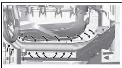
2. Verwenden Sie einen Gartenschlauch zur gründlichen Reinigung des Bereichs, so dass der Auspuff nicht mehr mit Schmutzresten in Berührung kommt.
