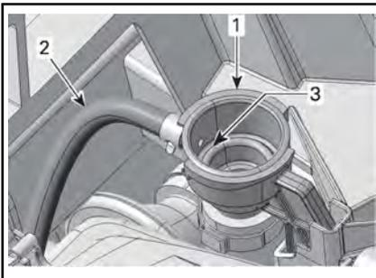
1. Adapter zum Auffüllen des Kühlsystems
