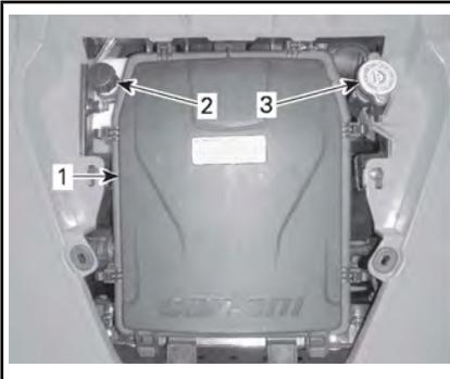
1. Deckel des Motor-Luftfilterkastens
