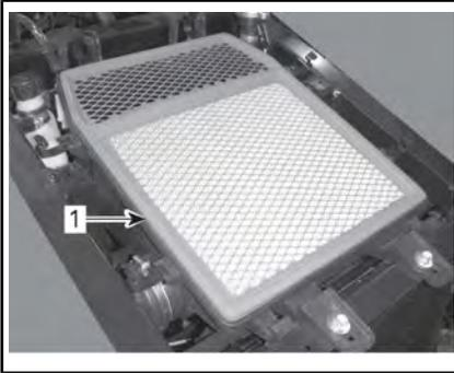
1. Filtro dell'aria del motore
