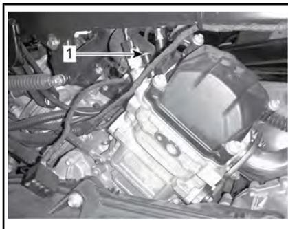
1. Vite di spurgo del cilindro posteriore
