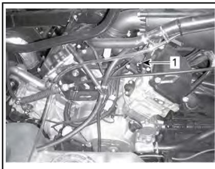
1. Vite di spurgo del cilindro anteriore
