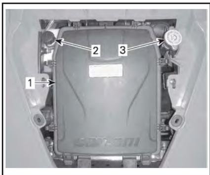
1. Dispositivo di copertura dell'alloggiamento del filtro dell'aria del motore
