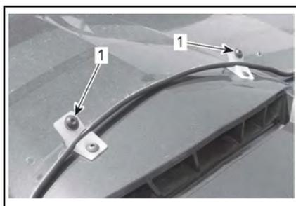
1. Soportes con los tornillos de sujeción y las arandelas instalados
