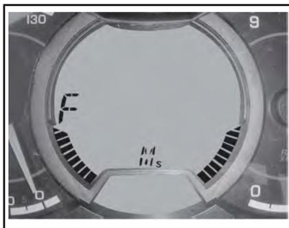
Pulse y mantenga pulsado el interruptor de ACS para subir o bajar la suspensión delantera hasta obtener el ajuste deseado.
