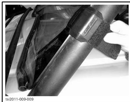
2. Retirer et conserver l'écrou de retenue, la rondelle et la vis qui fixe le pare-brise au support.
