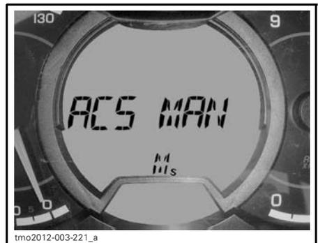
**REMARQUE:** Les indicateurs de carburant et de température deviendront respectivement des indicateurs de réglages ACS avant et arrière.
