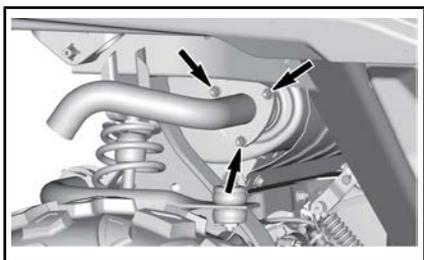
**TORNILLOS Y TUERCAS DE FIJACIÓN DEL TUBO DE ESCAPE**
