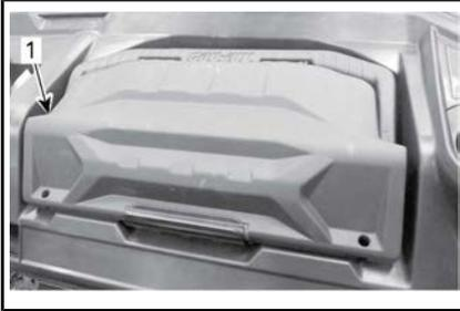
Para abrir la caja de herramientas, desbloquee el panel y levante la tapa.
