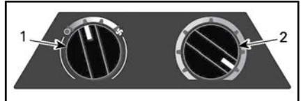
1. Botón de control de velocidad del ventilador del calefactor
