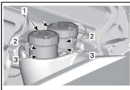
1. Los depósitos de líquido de frenos
