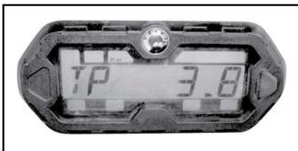
Puede utilizarse si se desea establecer un intervalo para repostar combustible o una distancia entre dos puntos de un itinerario.
