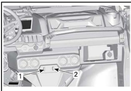
1. Botón de control de velocidad del ventilador del calefactor
