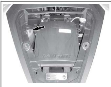
Der Kühlmittelstand muss sich an der **MIN**-Markierung befinden, wenn der Motor **KALT** ist.
