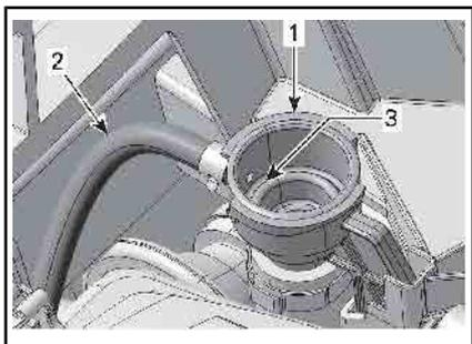
1. Adaptador de llenado del sistema de refrigeración
