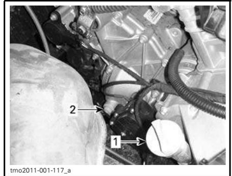
1. Bouchon de niveau d'huile du moteur
