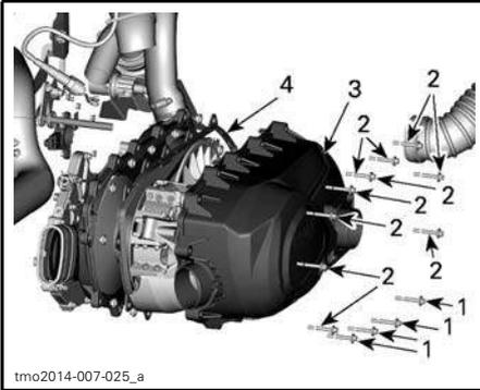
1. Vis inférieures du couvercle de transmission
