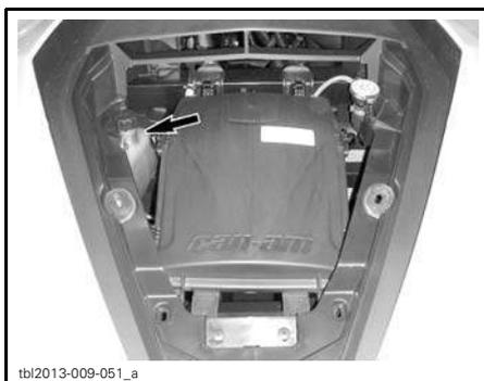
Le liquide de refroidissement devrait être à la marque **MIN** lorsque le moteur est **FROID**.
