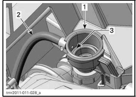
1. Goulot de remplissage du système de refroidissement
