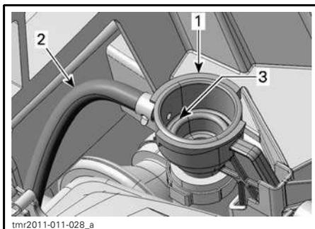
1. Goulot de remplissage de système de refroidissement
