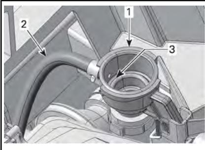
1. Adapter zum Auffüllen des Kühlsystems
