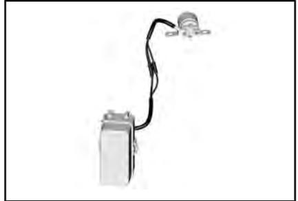
SCHMELZLOT VERBUNDEN MIT SICHERUNGSKASTEN
