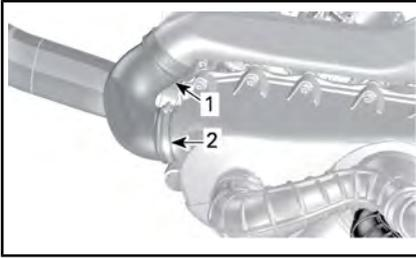
1. Auslassschlauch des stufenlosen Getriebes
