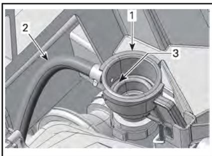
1. Adapter zum Auffüllen des Kühlsystems
