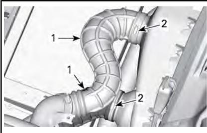
1. Einlassschlauch des stufenlosen Getriebes
