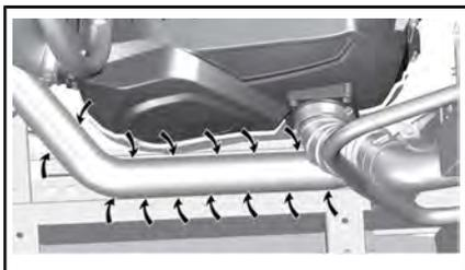
2. Verwenden Sie einen Gartenschlauch zur gründlichen Reinigung des Bereichs, so dass der Auspuff nicht mehr mit Schmutzresten in Berührung kommt.
