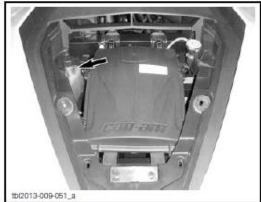
发动机处于冷却状态时, 冷却液液位应该位于**最低高度**标志之上。
