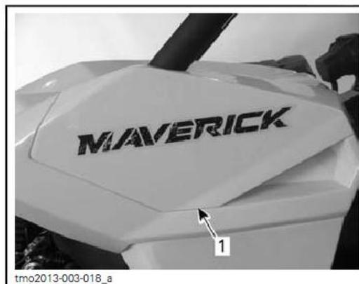
1. 无级变速器空气过滤器的塑料盖
