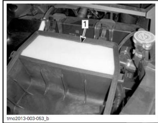
1. 发动机空气后置过滤器
