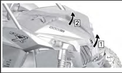
Schritt 1: Heben Sie die Vorderseite der Wartungsabdeckung weiter an
