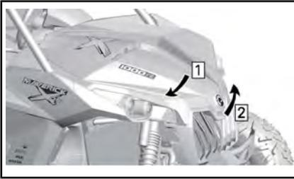
Schritt 1: Drücken Sie die Wartungsabdeckung herunter und HALTEN Sie diese fest
