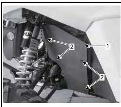
ZUGANG ZUR ABLASSSCHRAUBE VON DER LINKEN FAHRZEUGSEITE AUS
