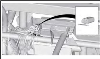
DRITTER SICHERUNGSKASTEN - HINTER OBERER KONSOLE BEI TURBO-MODELLEN
