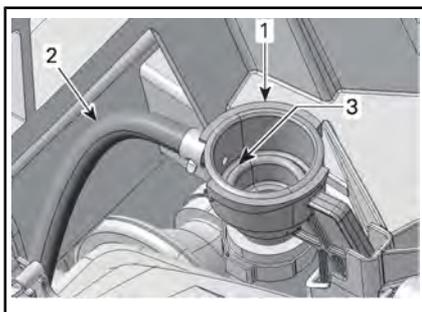
1. Adapter zum Auffüllen des Kühlsystems
