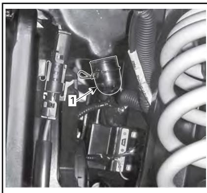
1. Entfernen Sie die Ablassschraube, um Wasser abzulassen
