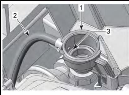
1. Adapter zum Auffüllen des Kühlsystems
