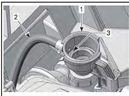
1. Adapter zum Auffüllen des Kühlsystems
