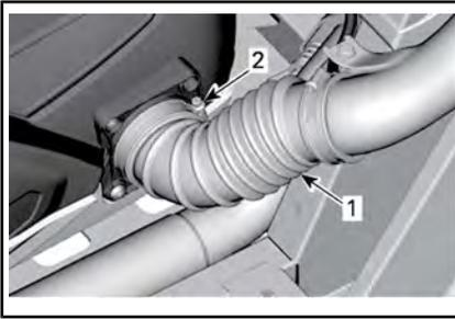
1. Einlassschlauch des stufenlosen Getriebes
