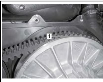
1. Unterster Teil der Zahnräder auf der Außenfläche des Antriebsriemen bündig mit der Kante der angetriebenen Riemenscheibe
