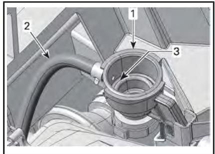
1. Adapter zum Auffüllen des Kühlsystems
