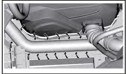
2. Verwenden Sie einen Gartenschlauch zur gründlichen Reinigung des Bereichs, so dass der Auspuff nicht mehr mit Schmutzresten in Berührung kommt.
