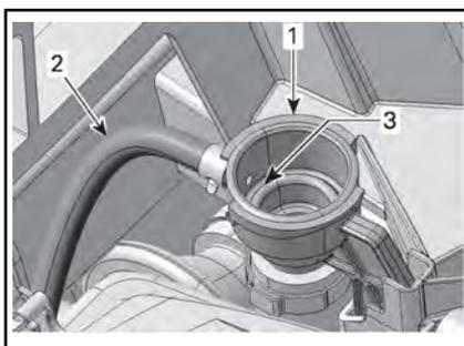
1. Adapter zum Auffüllen des Kühlsystems
