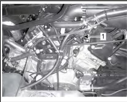
1. Entlüftungsschraube des vorderen Zylinders
