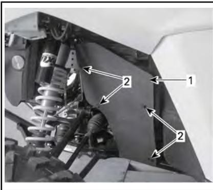
ZUGANG ZUR ABLASSSCHRAUBE VON DER LINKEN FAHRZEUGSEITE AUS - TYPISCH
