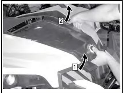
Schritt 1: Heben Sie die Vorderseite der Wartungsabdeckung weiter an
