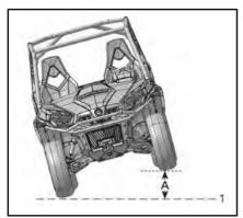
ELEVACIÓN DEL LATERAL DEL CONDUC-TOR
