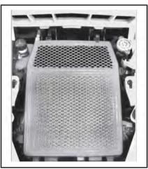
3. Compruebe que la tapa está bien colocada en el alojamiento del filtro de aire del motor antes de cerrar las sujeciones.
