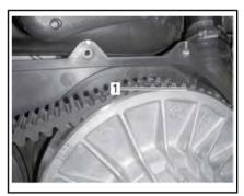
Parte inferior de los dientes a la altura de la superficie externa de la correa conductora
